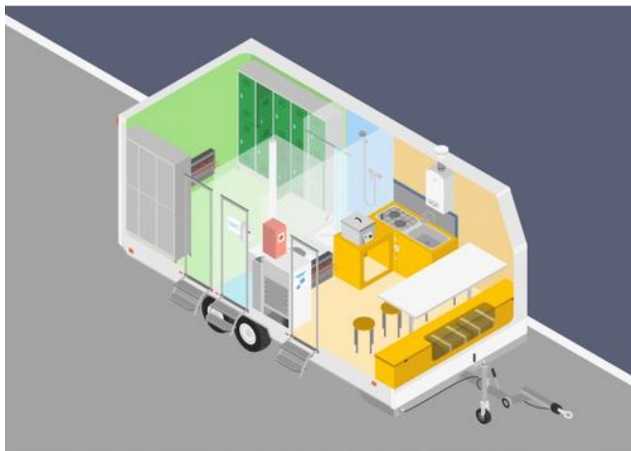
Aménagement d'une base vie autonome pour 8 compagnons Réfectoire/Vestiaire Douche / Sanitaire.
