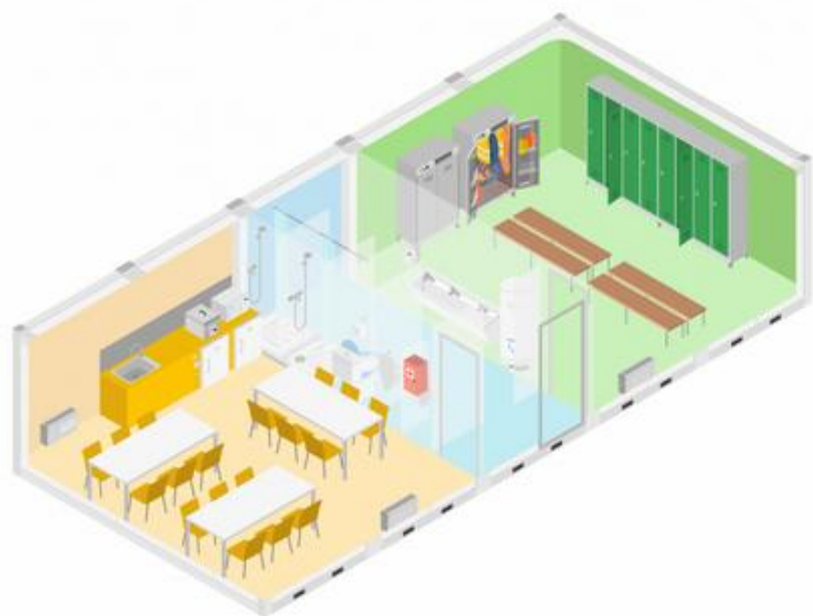
Vue intérieure d'une base vie modulaire raccordable pour 8 à 24 personnes à partir de modules de 6 x 2,5 m.
